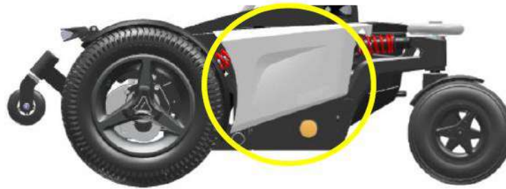
Figura 10-5: Caja de baterías
